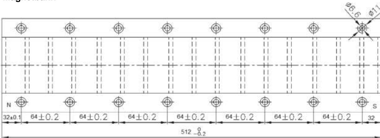
N/S - Prägung beachten für die Ausrichtung der Magnetbahnen
